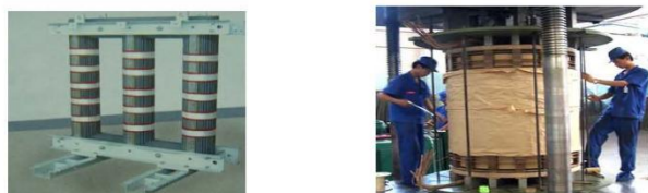
图 1—2 三相变压器的铁心和绕组
