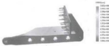
图8 滑动小车变形量图
