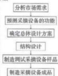
图1 番茄采摘设备的设计步骤
