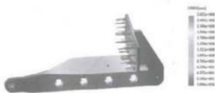
图8 滑动小车变形量图
